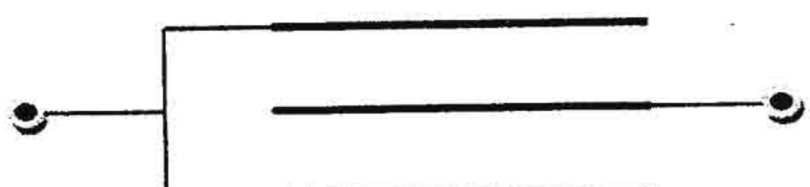
۹۴ - خارجی از سه تیغه فلزی مستطیل شکل، هر یک به ابعاد  $10\text{cm}$  و  $12\text{cm}$  ساخته شده است. دو تیغه بیرونی که در دو طرف تیغه میانی قرار دارند، مطابق شکل به یکدیگر متصل شده‌اند. اگر فاصله شکاف بین تیغه‌ها  $1\text{mm}$  و پرساز از هوا باشد، ظرفیت این سیستم چند پیکو فاراد است؟
