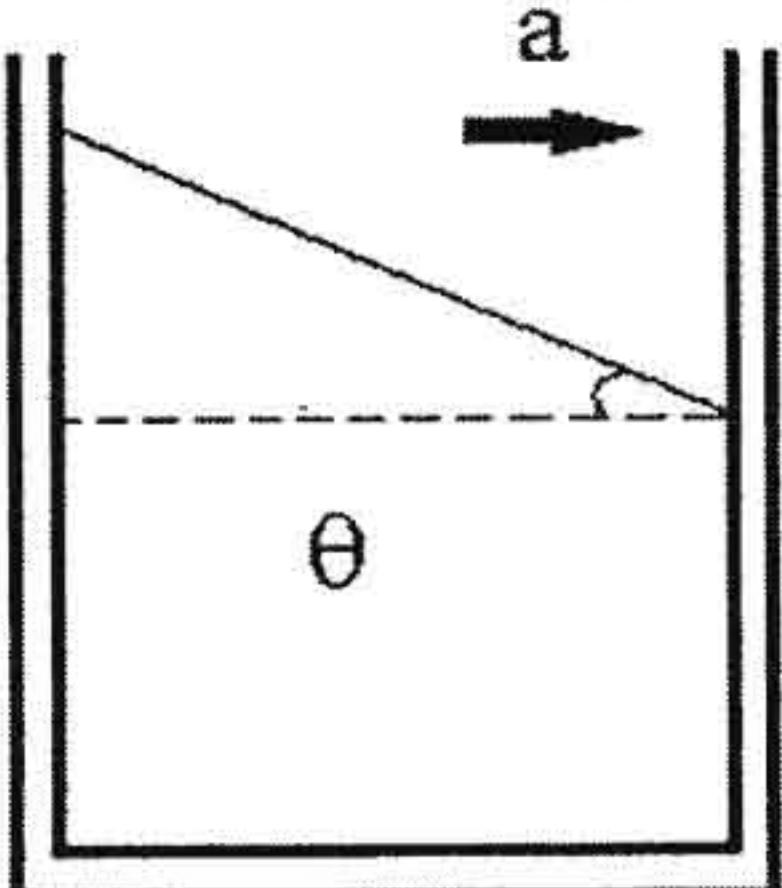
۵۴ - مخزن روباز محتوی مقداری مایع را که تحت اثر شتاب افقی قرار دارد، مطابق شکل در نظر بگیرید: شتاب افقی موجب می‌شود که سطح مایع در قسمت جلو مخزن پایین آمده و در قسمت عقب بالا رود. نشان دهید که سطح مایع نسبت به افق با زاویه  $\theta$  شیبدار می‌شود، که  $\tan \theta$  برابر است با:
